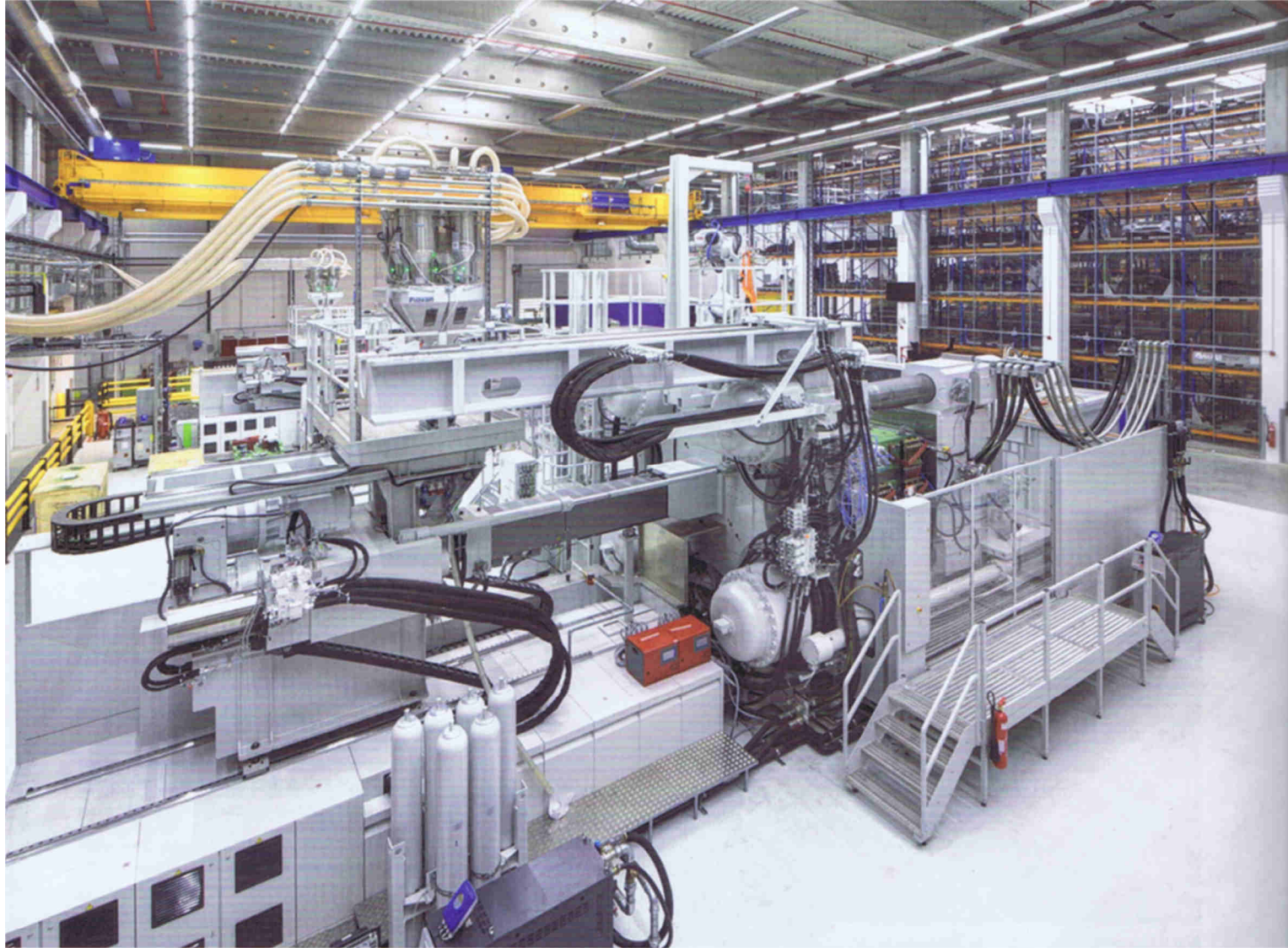
Bild 1: Die Spritzgussmaschinen werden mit Kühlwasser auf zwei verschiedenen Temperaturniveaus versorgt: 14 und 25 °C. Die höhere Temperatur wird direkt an der Maschine durch warmes Rücklaufwasser erzeugt. Bild: Gammel
